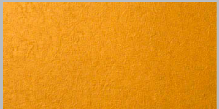
Gestupft: 1x MultiStructurStyle mittel, 2x GoldGrund, 2x CapaGold
