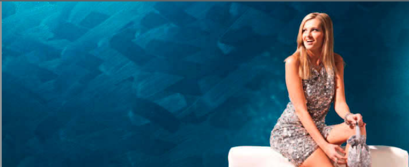
Wandfläche: 1x Amphibolin 3D Pacific 155 MET im Kreuzschlag gebürstet, 2x Metallocryl 3D Pacific 155 MET im Kreuzschlag gebürstet
